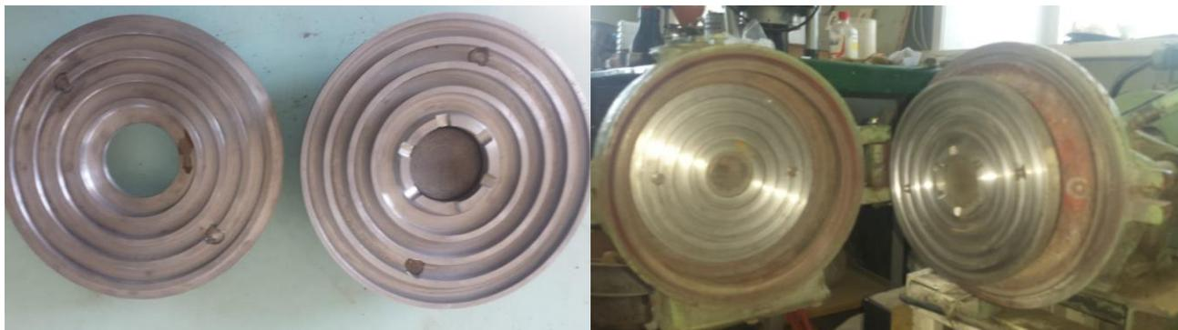
Рисунок 4.25 – Рабочие органы и рабочая камера лабораторной модели измельчителя
