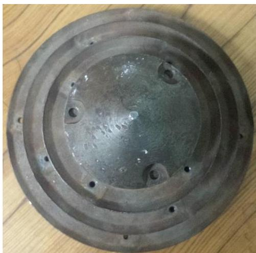
Рисунок 3.12 – Рабочий орган ступенчатой мельницы без дополнительных отбойных ребер
