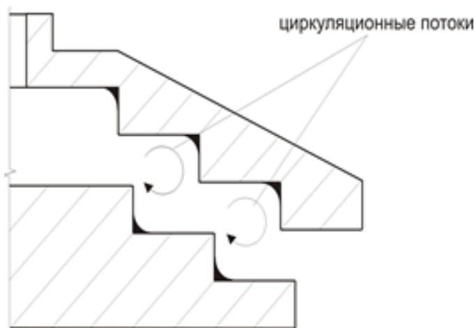
Рис. 2.12 - Схема циркулирующих потоков в рабочей камере ступенчатой мельницы
