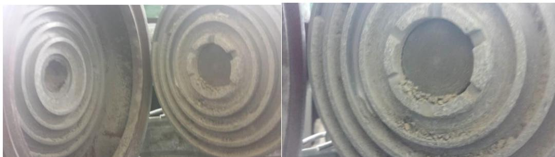
Рисунок 4.30 – Скопление неразрушенных частиц на отбойных элементах
