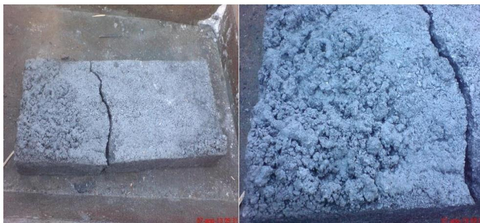
Рисунок 4.20 - Пробы с влажностью 30% и 40 % в замерзшем состоянии
