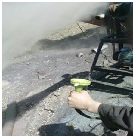
Рисунок 4.17 - Выброс тонкодисперсной пыли при работе мельницы ЦМВУ-800 в открытом режиме
