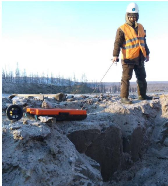
Рисунок 3.5 – Фотография георадара с антенным блоком «АБ-250М» на участке исследования
