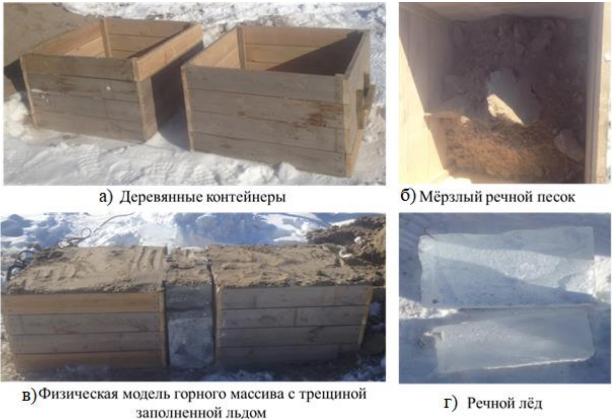
Рисунок 2.16 – Физическая модель горного массива с включением льда
