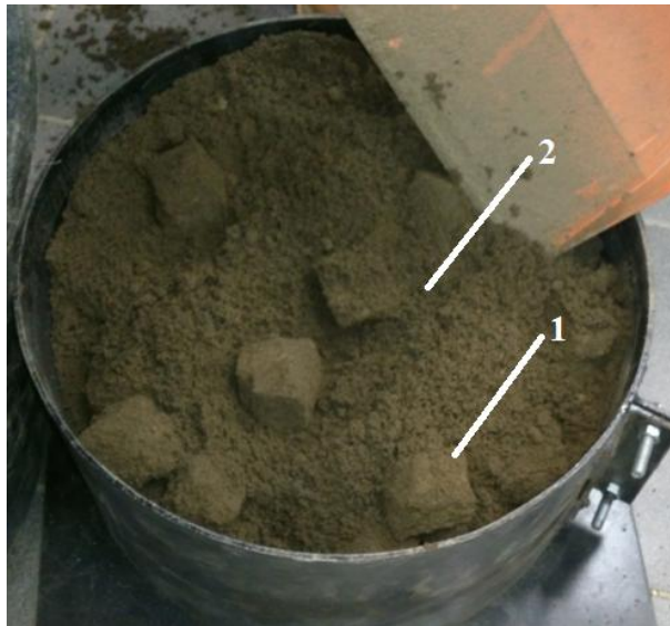
Рисунок 3.4 – Образец, структурно сопоставимый с взорванным массивом горных пород: 1 – включения; 2 – связующее
