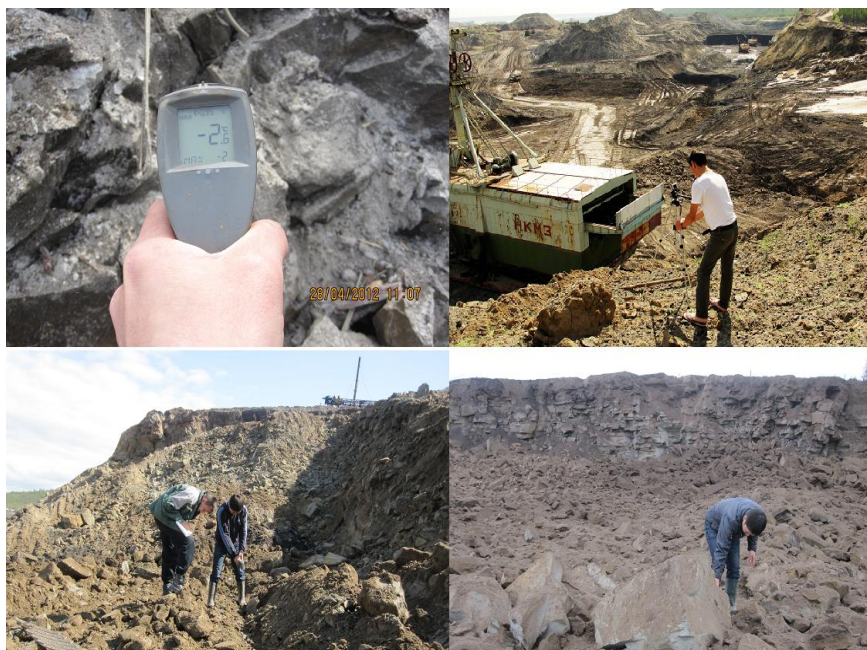
Рисунок 2.5 – Исследования температуры в забое экскаватора, фото, видеосъемка и хронометраж рабочего процесса драглайна
