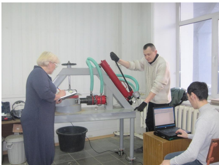
Рисунок 3.1 – Стенд для проведения испытаний на образцах, структурно сопоставимых с взорванным массивом ММГП
