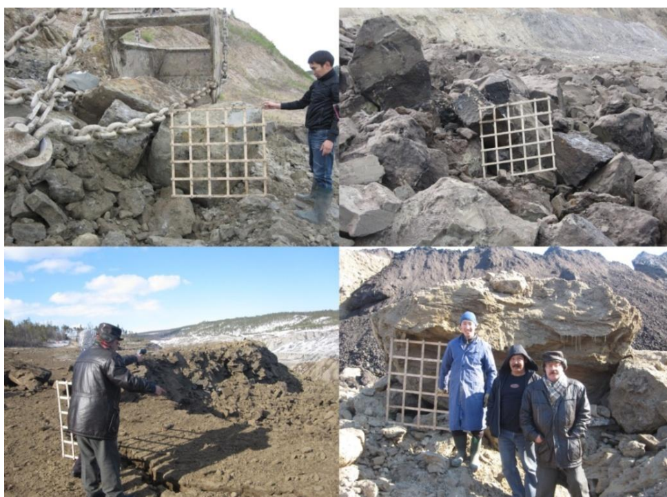
Рисунок 2.13 – Натурные исследования кусковатости планиметрическим методом
