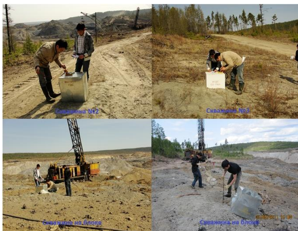
Рисунок 2.2 – Замер температуры в стационарных скважинах и установка термогирлянды во взрывные скважины
