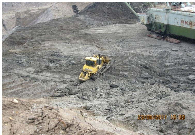
Рисунок 2.11 – Рыхление забоя экскаватора бульдозером-рыхлителем
