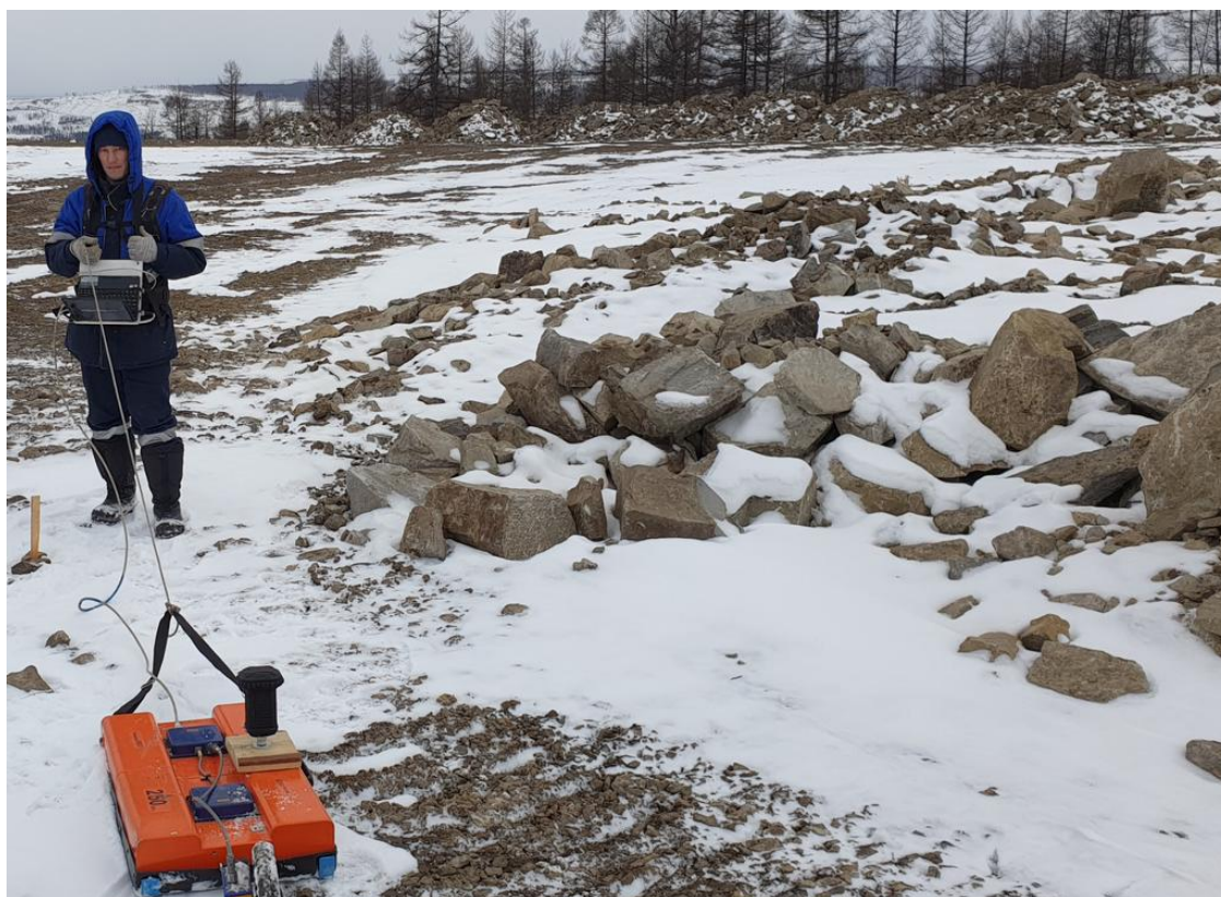
Рисунок 4.27 – Георадиолокационные площадные исследования на участке, ограниченном скоплением валунов и крупнообломочного материала
