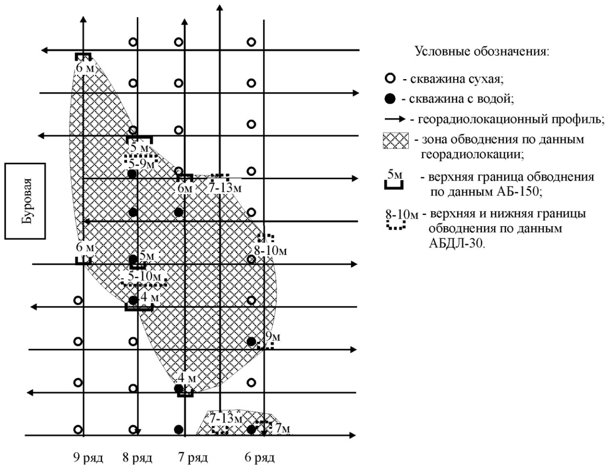
Рисунок 4.3 – Результат картирования зоны обводнения на вскрышном блоке №3 по данным георадиолокации
