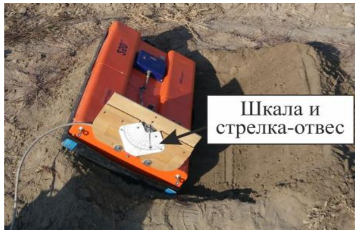
Рисунок 3.2 – Угловое георадиолокационное сканирование:
