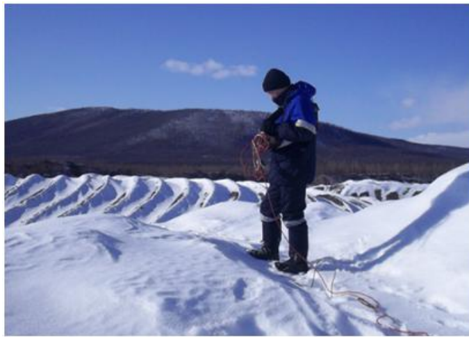
Рисунок 3.17 – Георадиолокационные исследования отвалов дражной отработки на месторождении россыпного золота р.Аллах-Юнь
