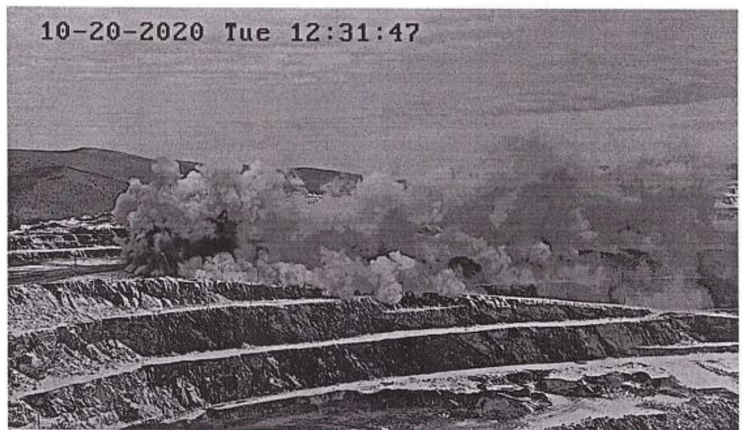
Рис. 4. Кадры развития взрыва экспериментального блока
