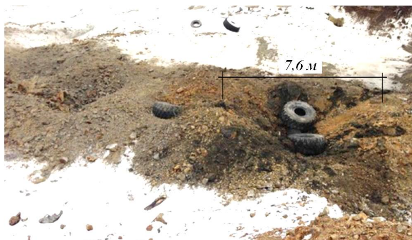
Рисунок 4.39 – Состояние блока МВ6 после взрыва с замедлениями 1000 мс
