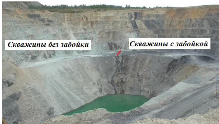
Рисунок 4.2 – Вид экспериментального блока МВ1 до взрыва
