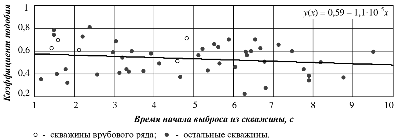
Рисунок 4.23 – Коэффициенты подобия скважин с K_{И} \geq 1 блока МВ3
