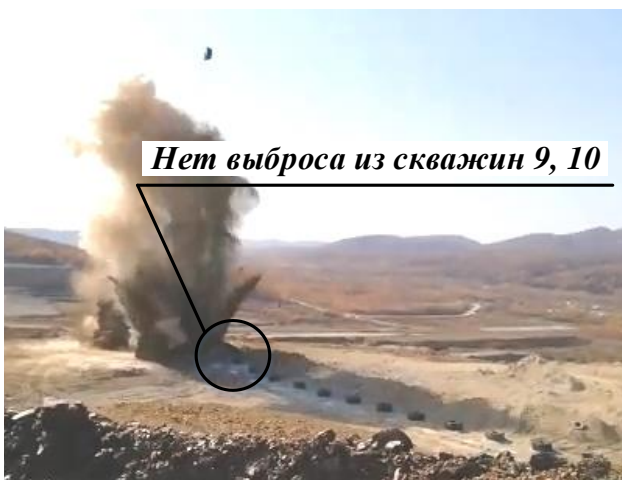
Рисунок 4.26 – Кадры развития массового взрыва блока МВ5
