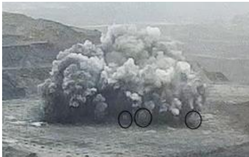
Рисунок 4.17 – Одновременный взрыв зарядов блока MB2
