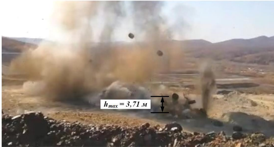
Рисунок 4.34 – Максимальная высота подброса автошины 15 блока МВ5
