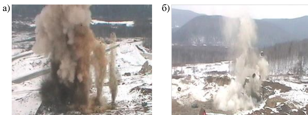
Рисунок 5 – Кадры развития взрывов блока МВ6 при замедлениях: а) 150 мс; б) 1000 мс
