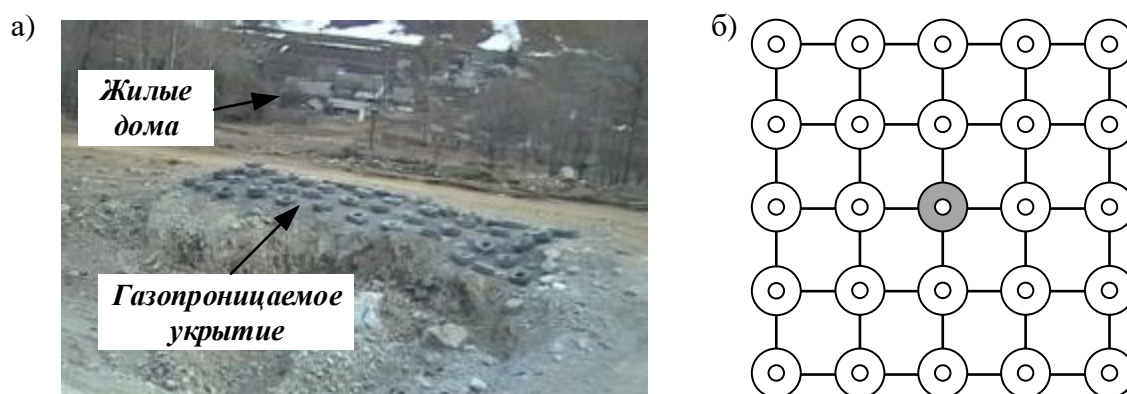
Рисунок 6 – Газопроницаемое укрытие из упругих элементов: а) общий вид; б) схема
